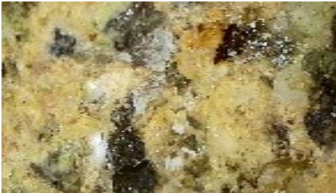
Fig 4 Microfotografía de superficie con desagregación granular. Microfotografía de superficie con desagregación granular.
